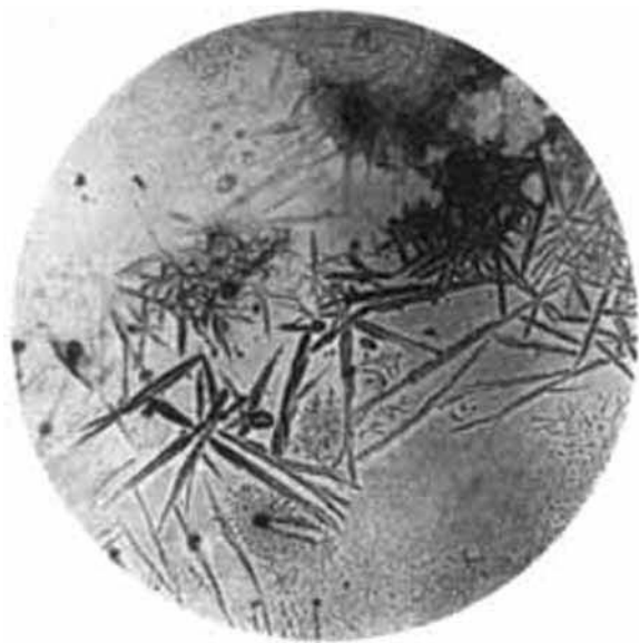
Abb. 2. Nachweis der kristallinen Beschaffenheit des Waxes von Abb. 1. Vergr. 55fach.
